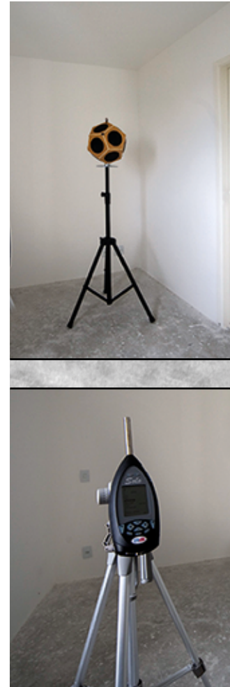
FIGURA 10 – FONTE DODECAÉDRICA OMNIDIRECIONAL E SONÔMETRO
