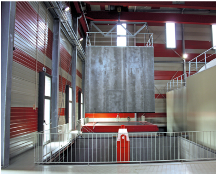
FIGURA 6B - CÂMARA VERTICAL PARA ENSAIOS DE RUÍDO DE IMPACTO
