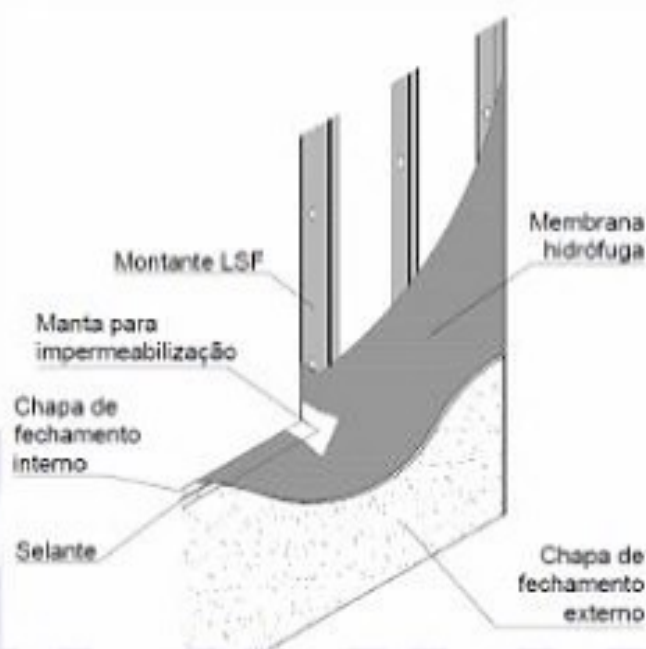
Figura 2 – Detalhe de vedação dos vãos das aberturas
